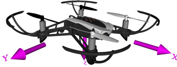
Bild 2.1: Quadrokopter Parrot Mambo mit beschrifteten Achsen [Mat]
